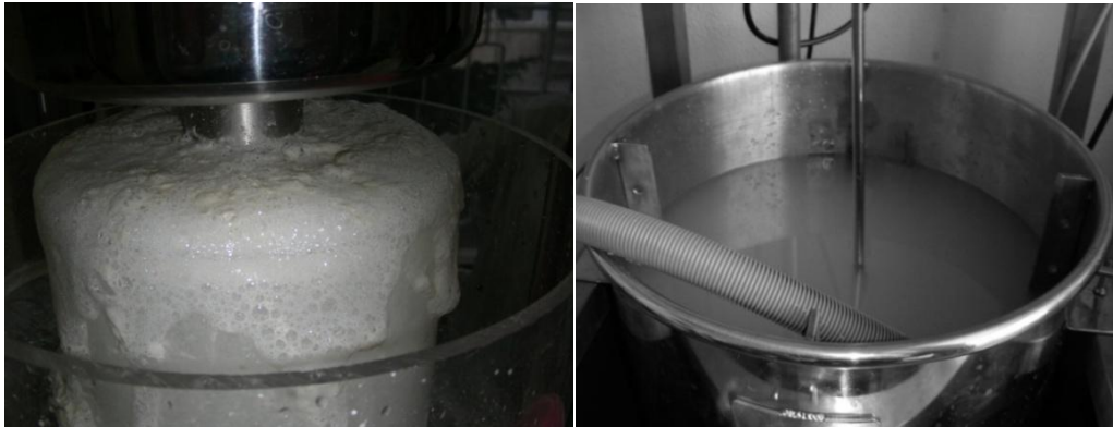
Şekil 5.6. Jameson flotasyon hücresi ve koşullandırma tankı
