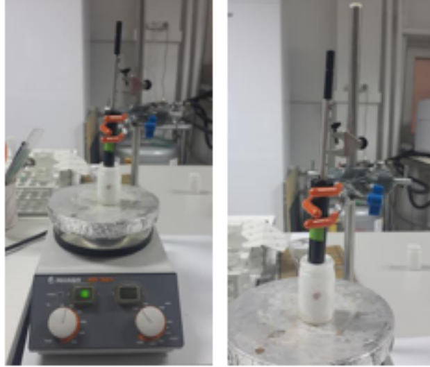
Şekil 3.10 Manuel KFME kullanılarak uçucu bileşenleri adsorpsiyonu
