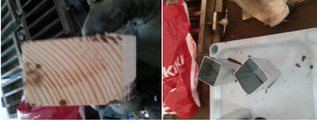
Şekil 5.2. Alt tabaka betonlarının hazırlanmasında kullanılan 45 derece eğimli ahşap ve metal kalıplar
