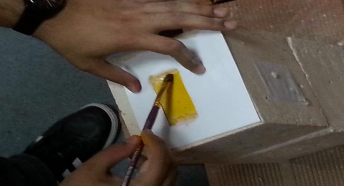
Şekil 4.18. Beton yüzeyine Phenantroquinone sürülmesi işlemi.
