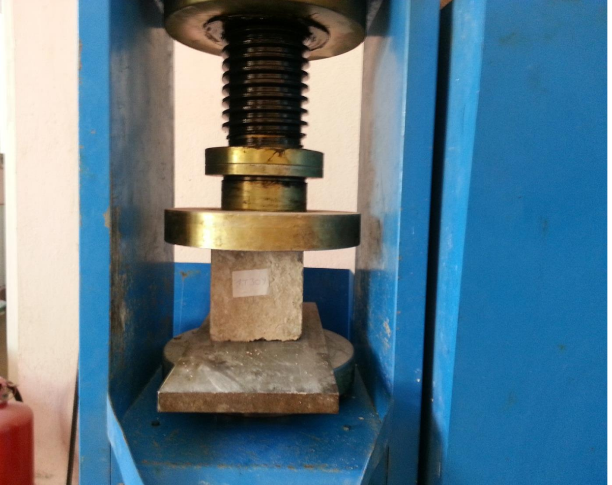
Şekil 4.9. Pres makinesi ile beton numunesinin kırılması işlemi.
