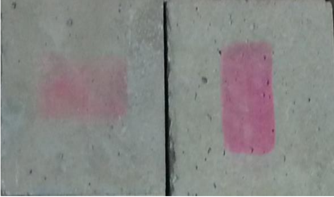
Şekil 5.4. % 3 ve % 0 oranında TiO_2 içeren uçucu küllü numunelerin 28 gün sonu görüntüleri.
