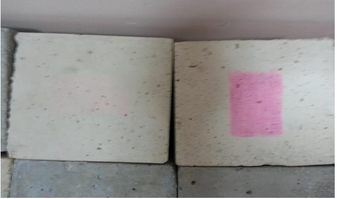
Şekil 5.14. % 5 ve % 0 oranında TiO_2 içeren sepiyolitli betonlardaki renk açılması farkı.
