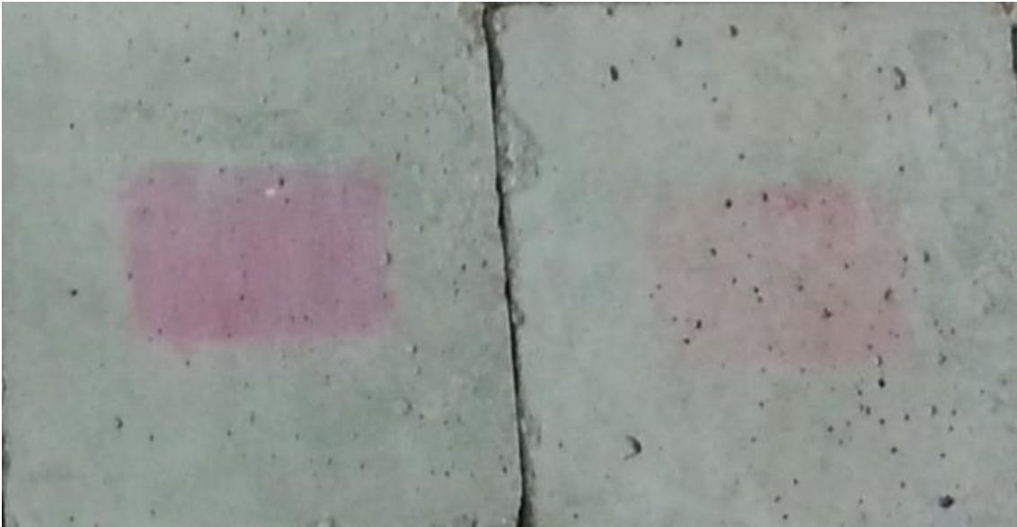
Şekil 5.5. % 1 ve % 5 oranında TiO_2 içeren uçucu küllü numunelerin 28 gün sonu görüntüleri.
