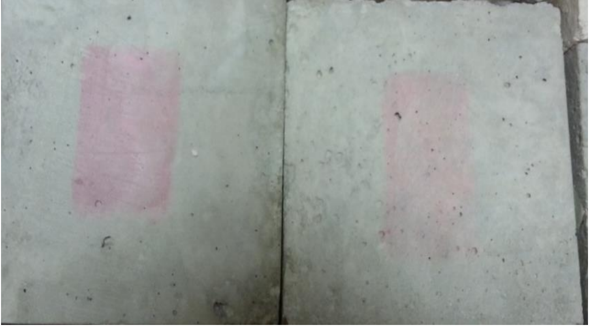
Şekil 5.9. % 1 ve % 5 oranında \text{TiO}_2 içeren yüksek fırın cürüflu numunelerin 28 gün sonu görüntüleri.
