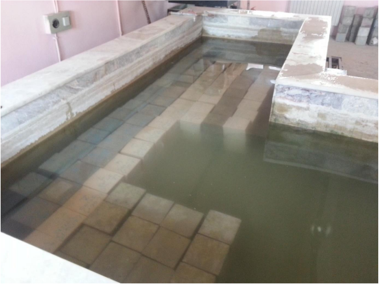
Şekil 4.6. Kür havuzuna bırakılan beton numuneler.
