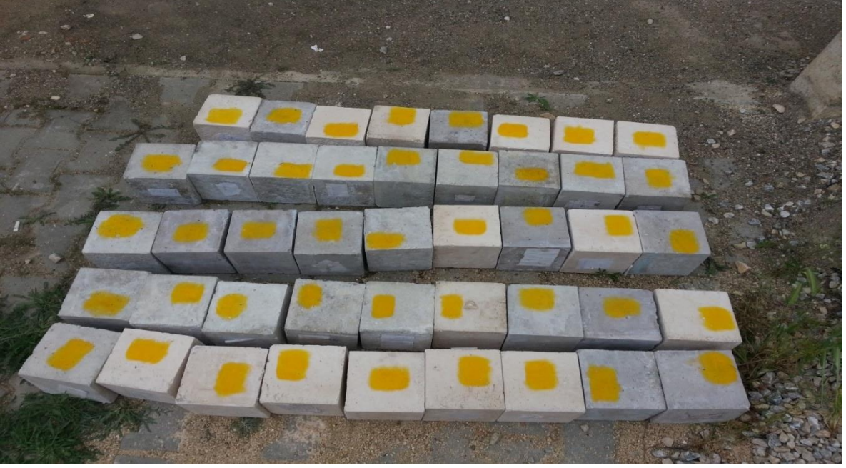
Şekil 4.20. Dış ortama (açık havaya) bırakılan Phenantroquinone boyalı numunelerin görünümü.
