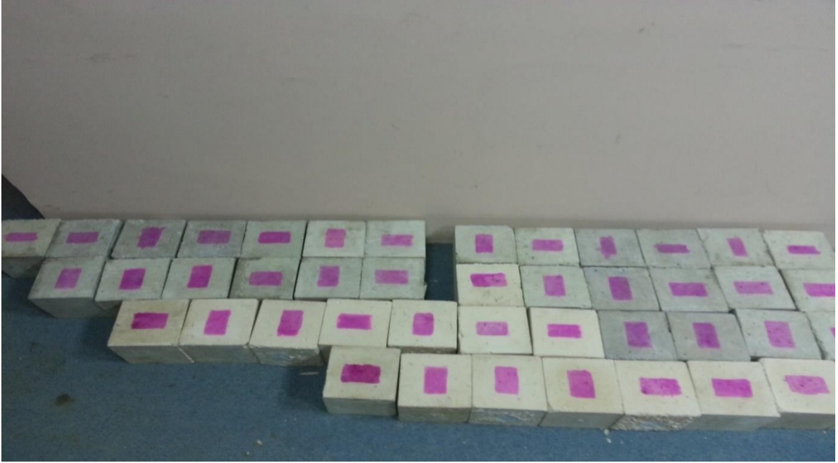
Şekil 4.14. Yüzeyine Rhodamine-B sürülmüş beton numunelerinin genel görünüşü.
