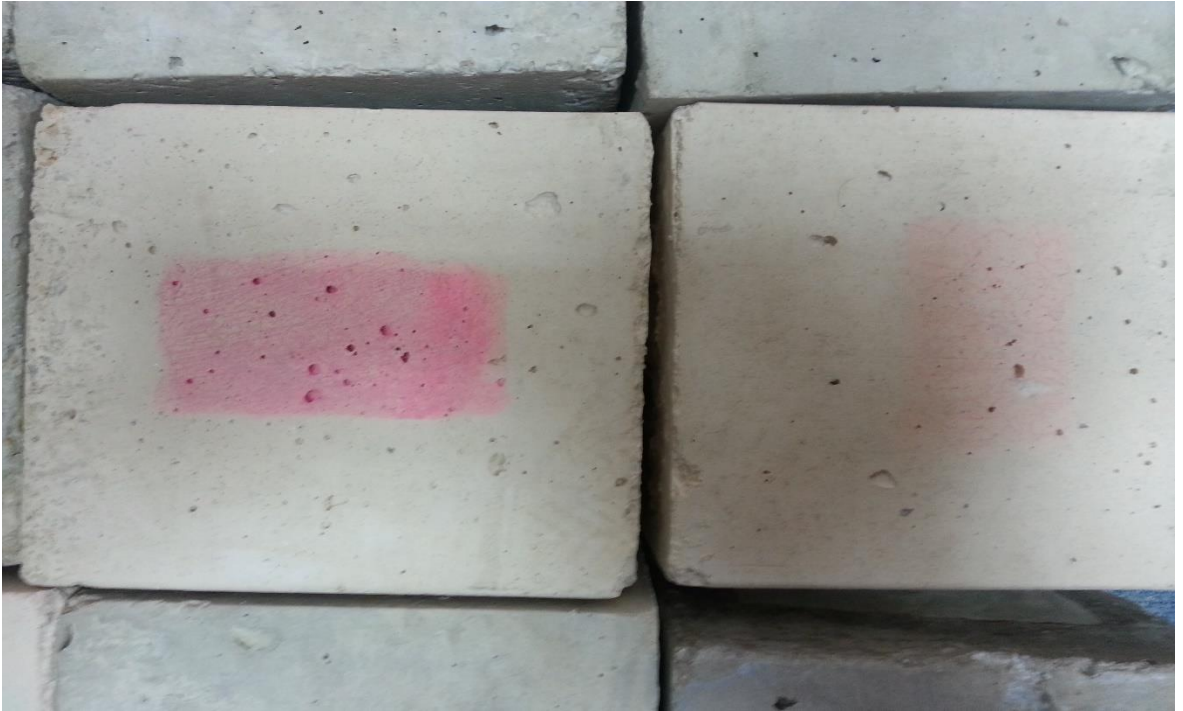
Şekil 5.15. % 1 ve % 3 oranında TiO_2 içeren sepiyolitli betonlardaki renk açılması farkı.
