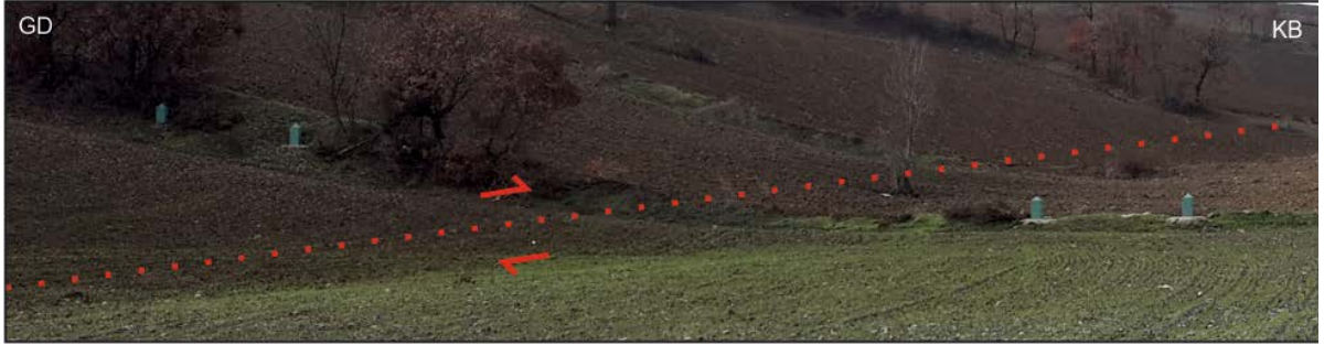
Şekil 5.26. Sepetli istasyonu. 4. lokasyona beton direklerin inşasından sonra alanın görüntüsü (kırmızı kesikli çizgi fay uzanımını göstermektedir).
