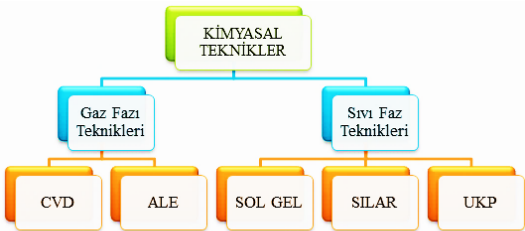
Şekil 4.1. Kimyasal film üretim tekniklerinin sınıflandırılması.
