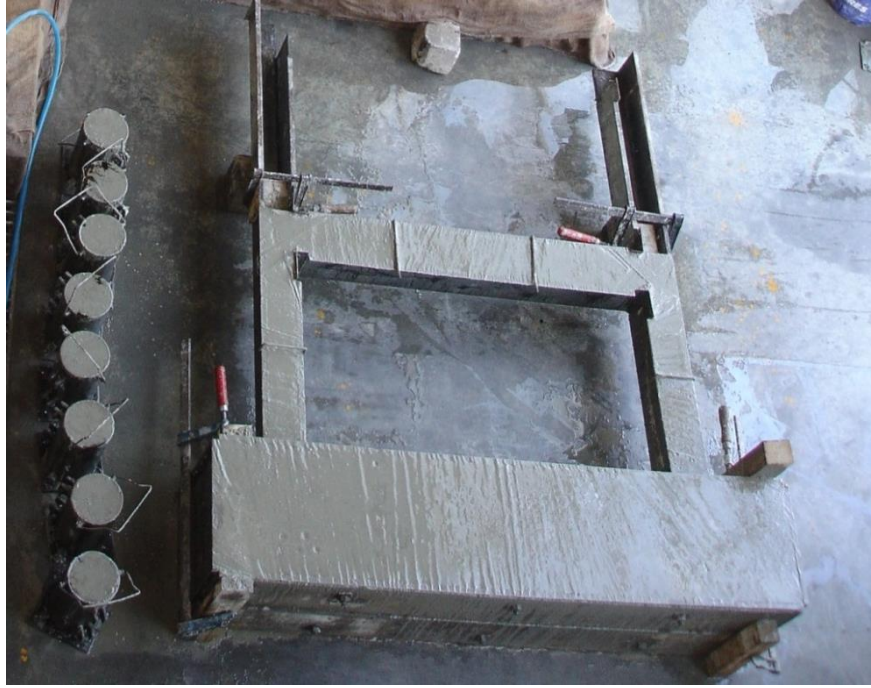
Şekil 3.2. Deney elemanı beton dökümü ve silindir numuneler
