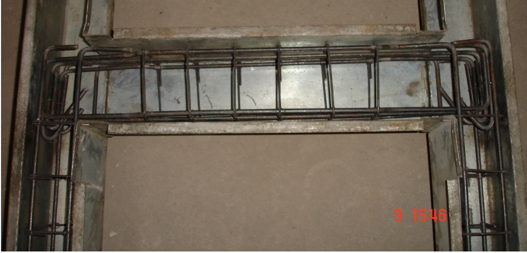
Şekil 3.6. Kiriş ve kolon-kiriş birleşim bölgeleri
