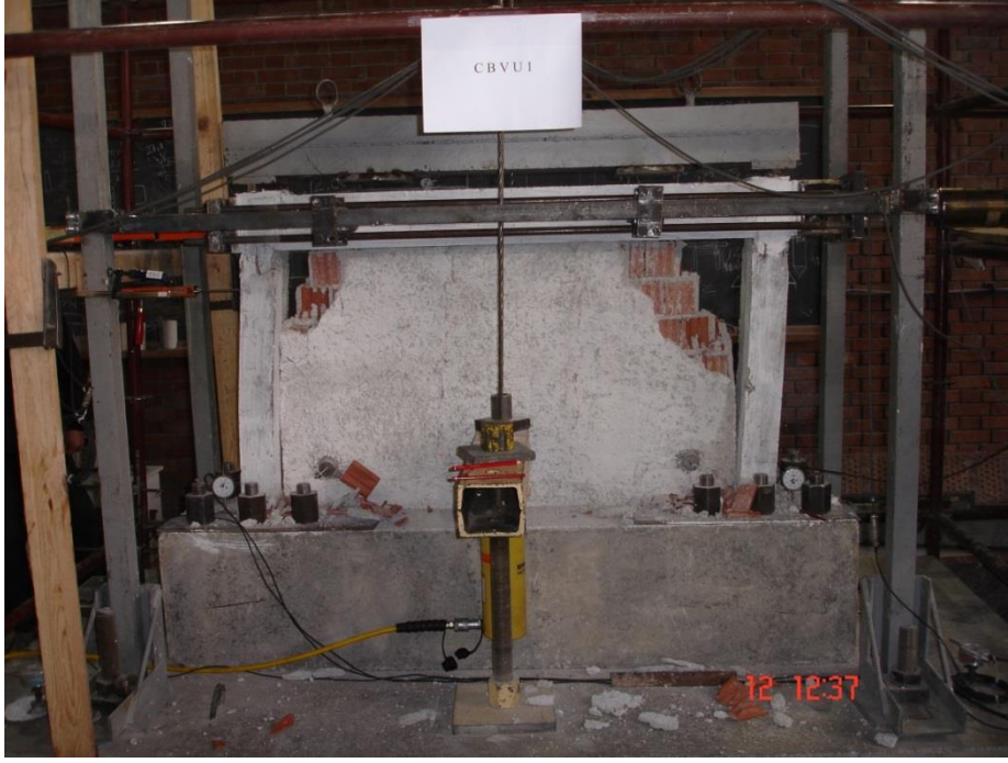
Şekil 3.15. Deney sonucunda deney elemanında gözlenen hasar
