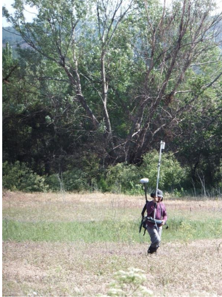
Şekil 3.8. Geometrics G-858 sezyum buharı manyetometresi ve RTK-GPS ile ölçüm.
