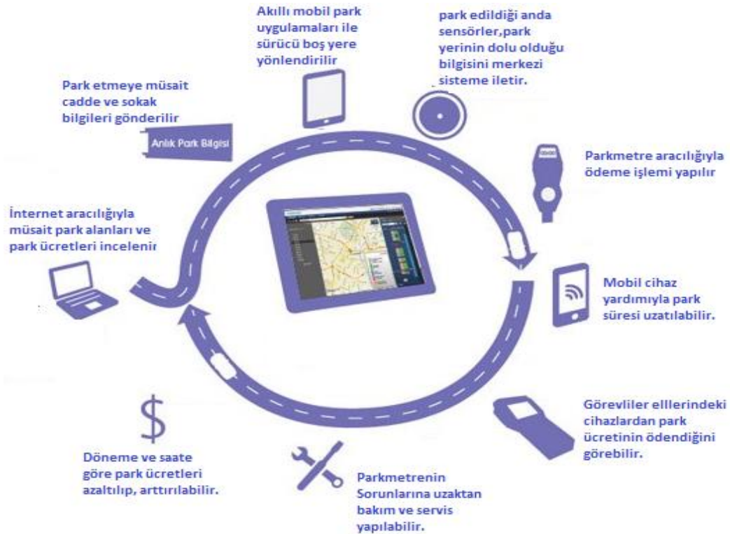
Şekil 6.10. Akıllı Otopark Sistem İşleyişi (Anonim, 2015)
