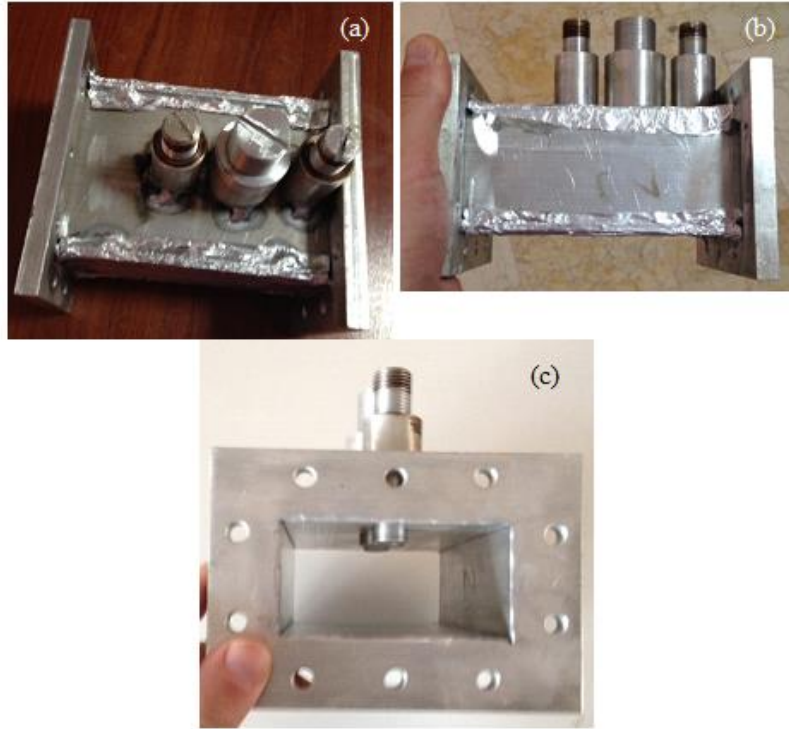
Şekil 5.12. Saplamalı ayarlayıcı a) üstten, b) yandan, c) içten görünüm.
