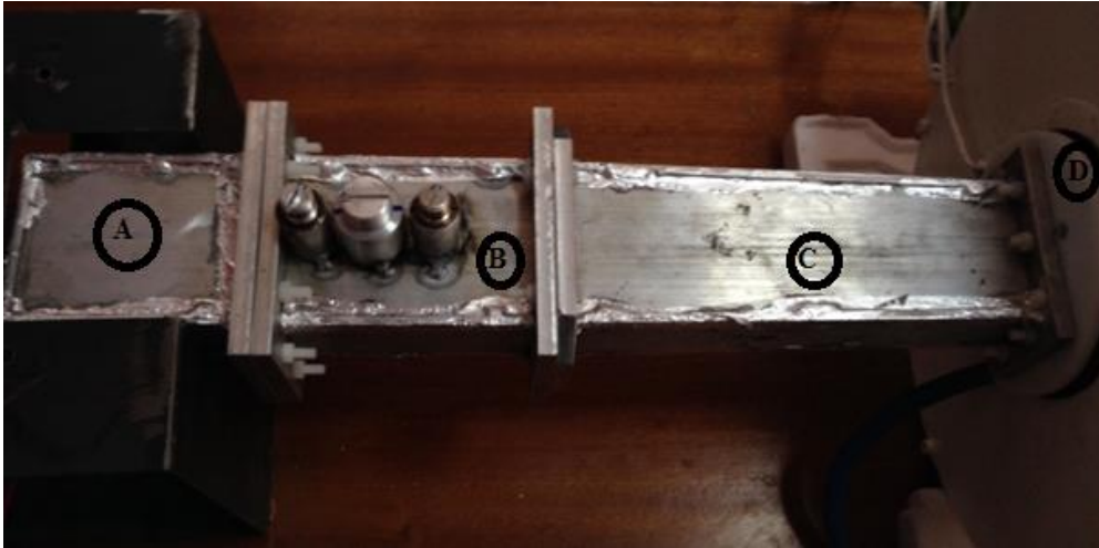
Şekil 5.21. Mikrodalga transfer hattı üstten görünümü (A: Magnetron kafası, B: Saplamalı ayarlayıcı, C: WR340'dan WR284'e geçiş dalga kılavuzu, D: Elektriksel yalıtım).
