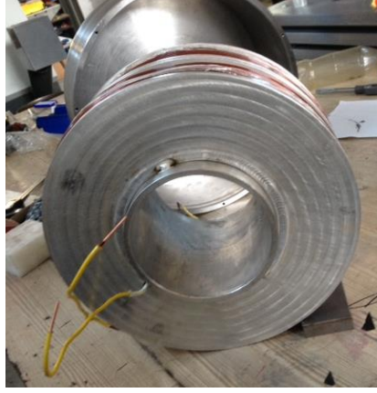
Şekil 5.28. Elektromıknatısın yandan görünüşü ve su kanalları.
