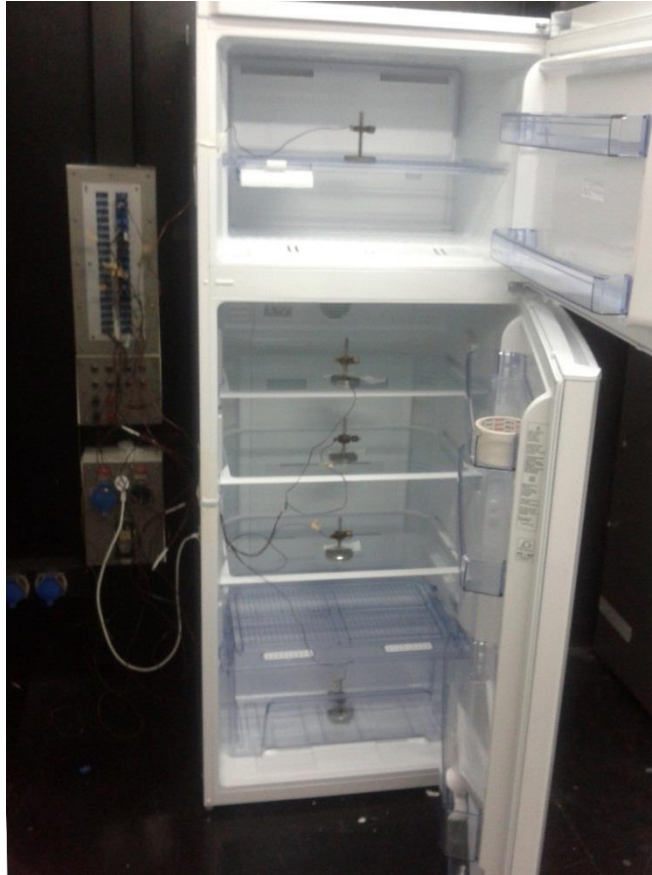
Şekil 4.3. Buzdolabının içine ısı çiftlerin yerleştirilmesi
