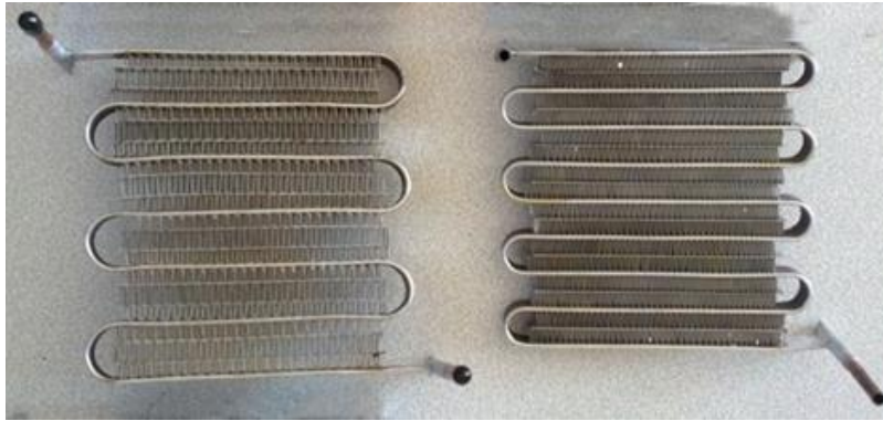
Şekil 4.1. Deneysel olarak kullanılan çift ve tek ara sıralı minikanal numuneleri
