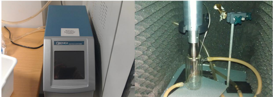
Şekil 3.2. Yüksek şiddete ultrases uygulama düzeneğinin fotoğrafı.
