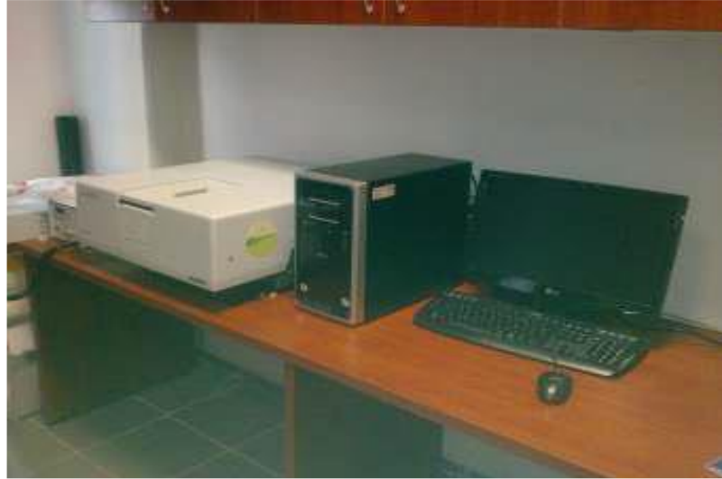
Şekil 3.3. Shimadzu UV-VIS 2550 Spektrofotometre cihazının fotoğrafı.
