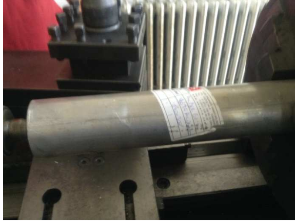
Şekil 5.5. İşlenecek malzemenin tezgâha bağlanması.
