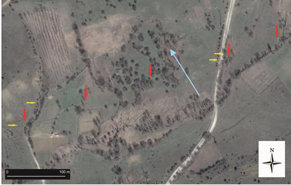
Şekil 6.44. Afşartarakçı Köyü'nün kuzeydoğusunda fayın uzanımı. Sarı oklar sağ yanal ötelenmiş dereyi ve ağaç sırasını, kırmızı oklar fayın izini göstermektedir. Mavi çizgi GPR profilinin yerini göstermektedir.
