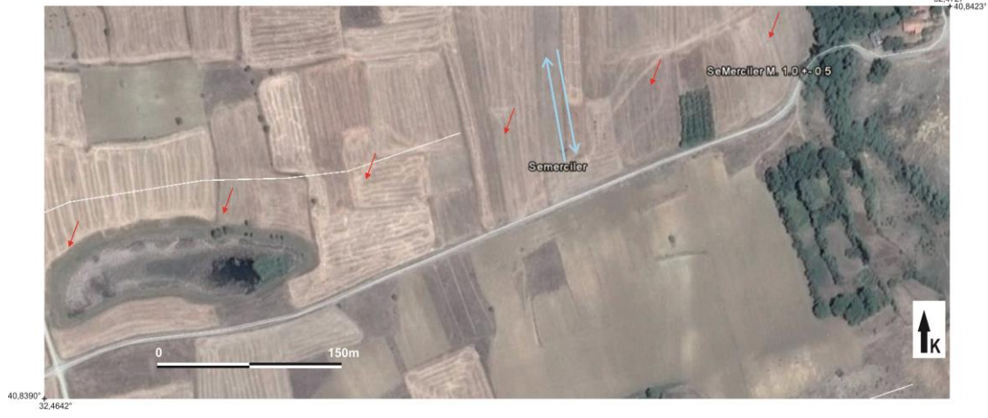
Şekil 6.48. Semerciler Köyü'nün batısında fayın uzanımı. Kırmızı oklar fayın izini göstermektedir. Mavi çizgi GPR profilinin yerini göstermektedir.
