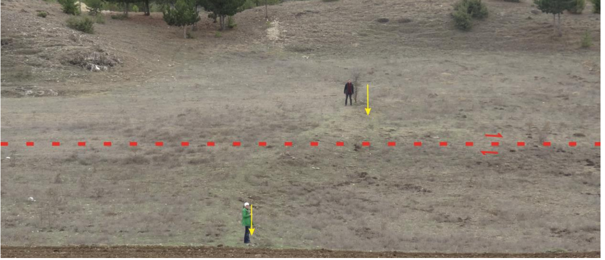
Şekil 6.20. Hamamlı'nın yaklaşık 2 km doğusunda tarla sınırında (sarı oklar) gözlenen sağ yanal yamulma, kesikli kırmızı çizgi fayı göstermektedir.
