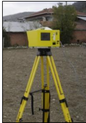
Şekil 8.1. Eskişehir Osmangazi Üniversitesi bünyesinde bulunan Optech Marka ILRIS HD+ER model yersel LİDAR cihazı.
