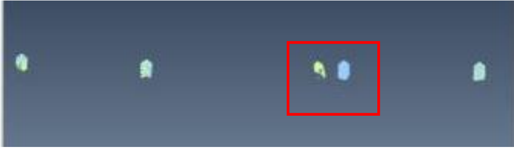
Şekil D.5. İsmetpaşa istasyonunda Aralık 2014 (Yeşil renk ile gösterilen ölçüm) ve Eylül 2014 (mavi renk ile gösterilen ölçüm) de yapılan ölçümlerin üst üste giydirilmiş şeklinde hasar gören direk kırmızı kare içerisinde görülmektedir.
