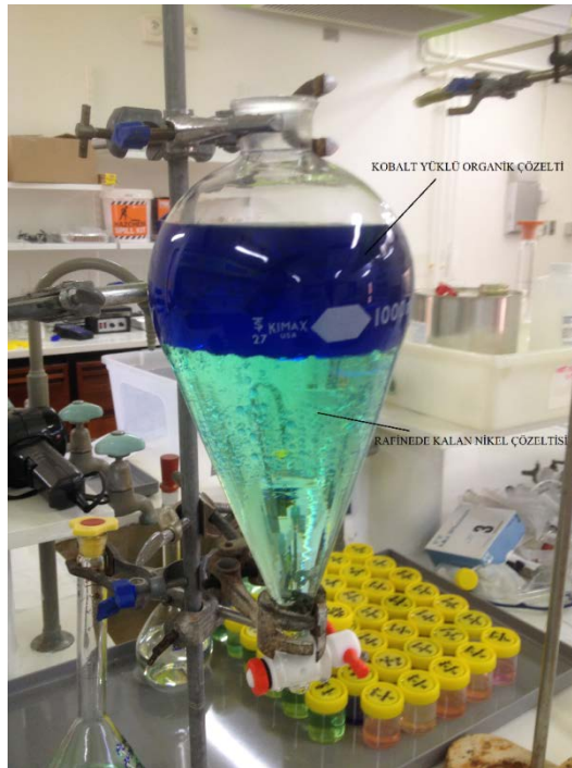
Şekil 5.23. Ekstraksiyon sonrasında pH 5 değerinde yüklü organik ve rafine görüntüsü.
