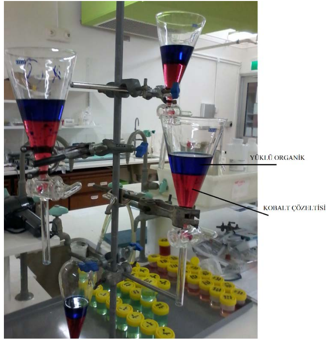
Şekil 5.24. Yüklü organik çözeltinin 20 \text{ g L}^{-1} kobalt çözeltisiyle temizleme aşaması.
