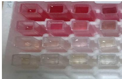
Şekil 4.5. Dolgu maddesi aktif karbon ve toz demir talaşı olan reaktörde farklı boya derişimlerinde renk giderimi
