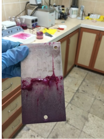
Şekil 4.7. Arıtım sonrası elektrotların durumu
