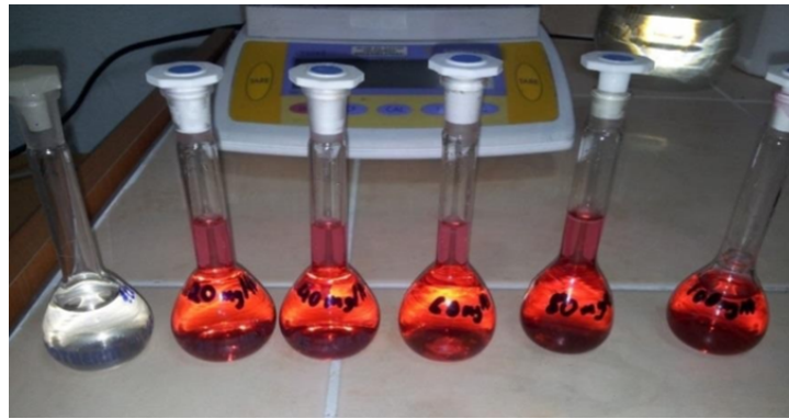
Şekil 4.2. Kalibrasyon için 10-60 mg/L derişim aralığında hazırlanan çözeltiler
