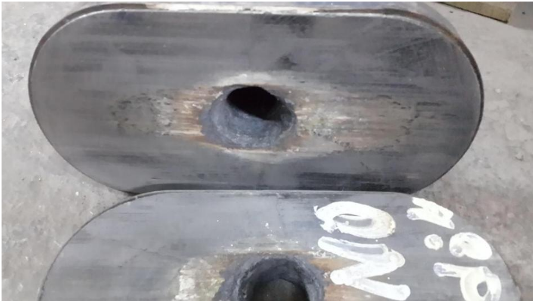
Şekil 6.38. 5 Döküm kullanım sonrası sökülme sabit (üst) plaka
