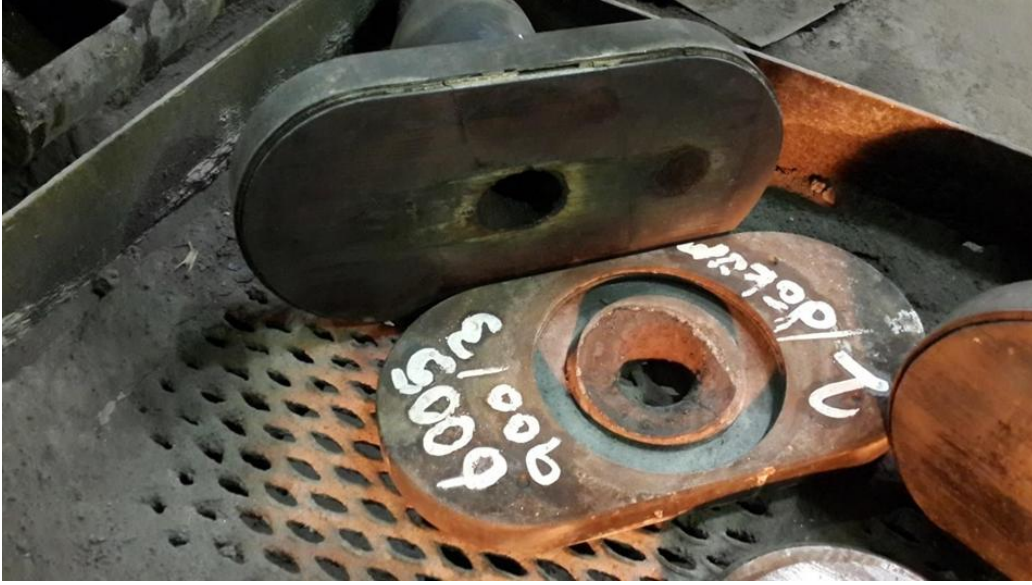
Şekil 6.40. 2 döküm sonrası alt ve üst plaka görünümü
