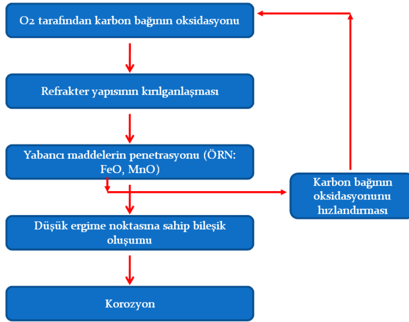
Şekil 4.1. Yüksek oksijen çeliği aşınma modeli (Sugino vd., 1993)
