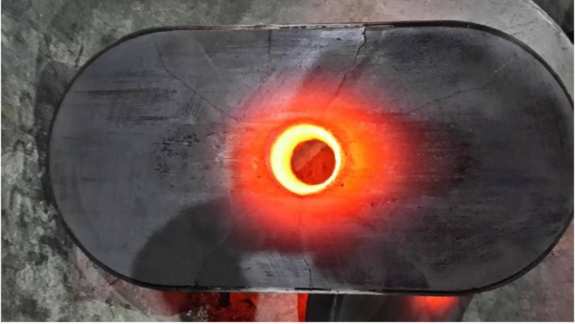
Şekil 6.39. 5 Döküm kullanım sonrası potadan devre dışı kaldığı durumu
