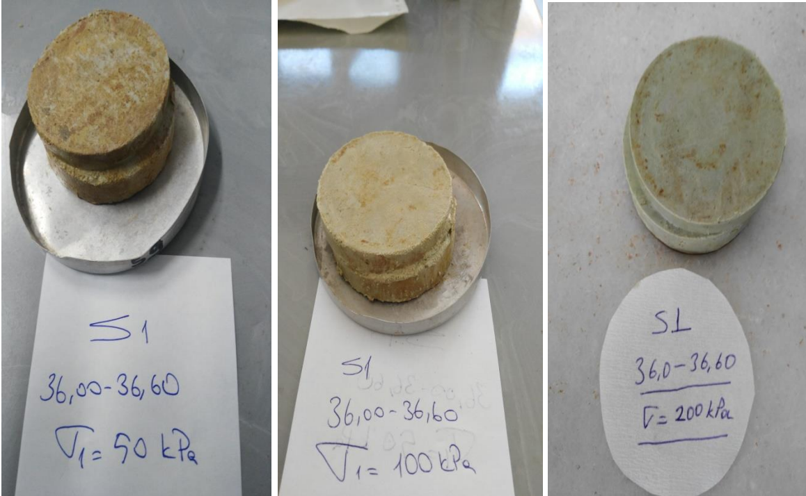
Şekil 4.18. Kesme Kutusu Deney Numuneleri (Deney Sonu)
