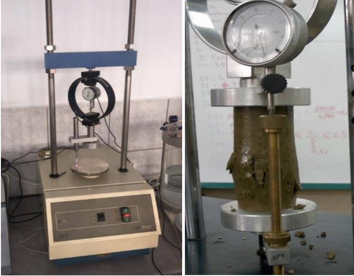
Şekil 3.10. Serbest basınç deney aleti(ESOGÜ) ve serbest basınç numunesinin yenilme anı
