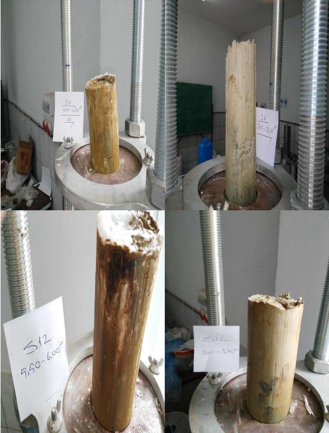
Şekil 4.3. Numunenin tüplerden çıkarılışı
