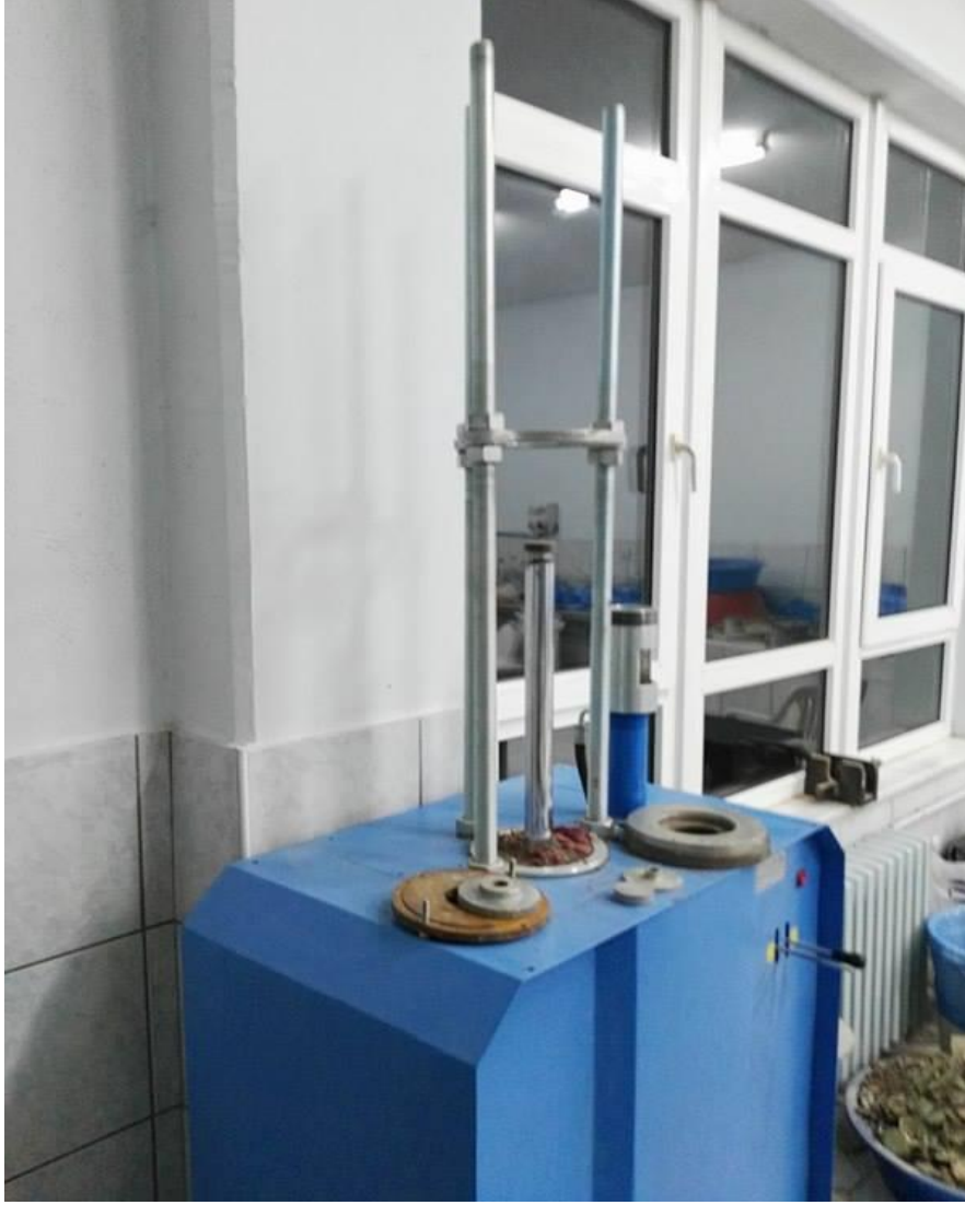
Şekil 4.2. Tüplerden numuneyi çıkarmak için kullanılan kriko(ESOGÜ)
