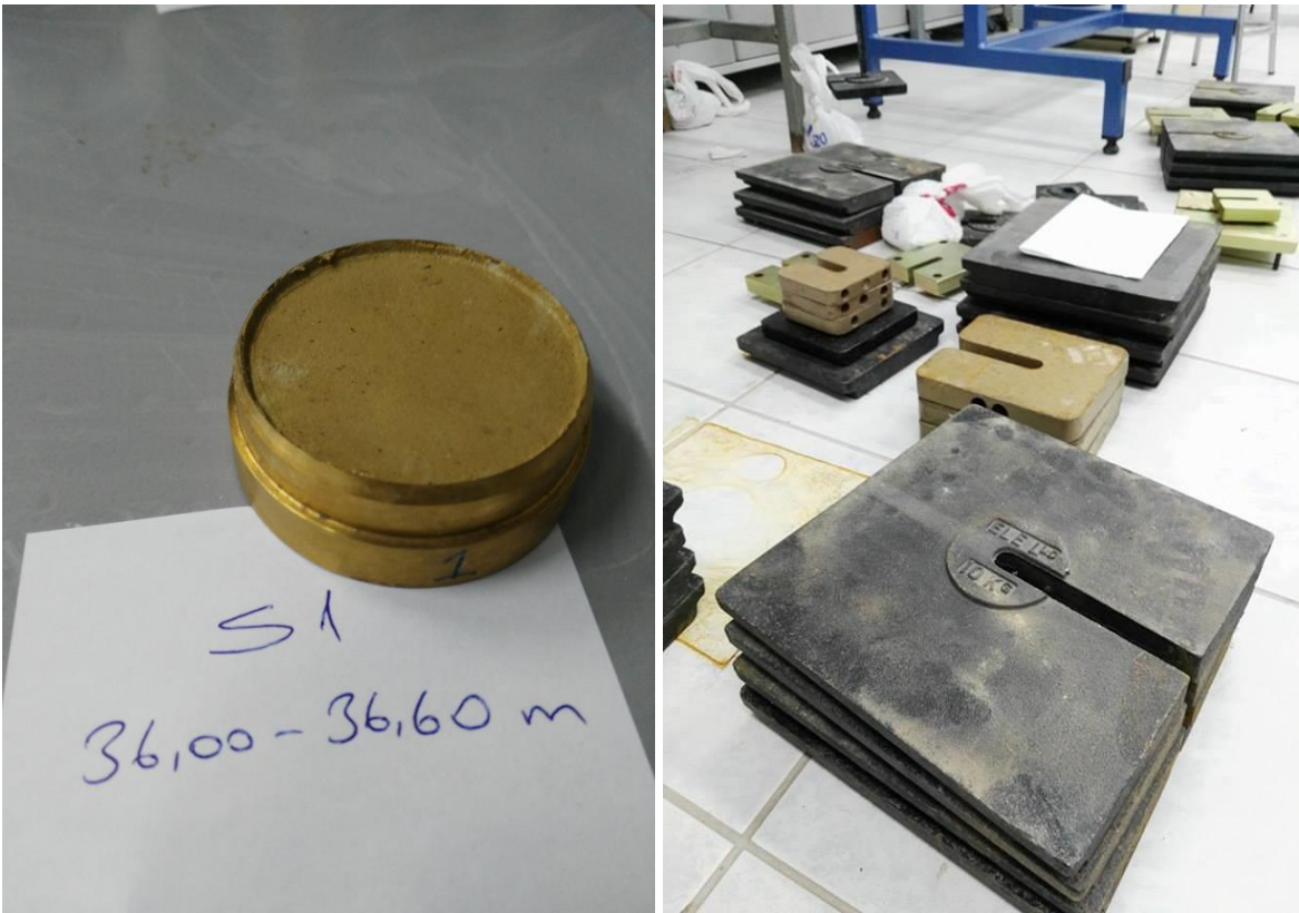
Şekil 4.14. Konsolidasyon Deney Numunesi(Deney Sonu) ve yükleme ağırlıkları
