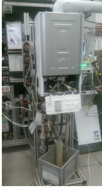
Şekil 8.9 Yoğuşma suyu debi ölçümü Şekil 8.10 Ölçekli kaptaki yoğuşma suyu miktarının ölçülmesi
