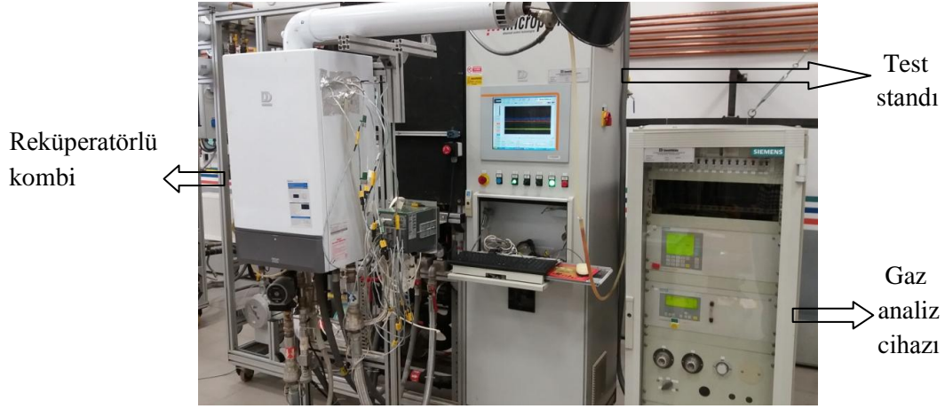
Şekil 8.4. Kombi, test standı ve gaz analiz cihazı görseli
