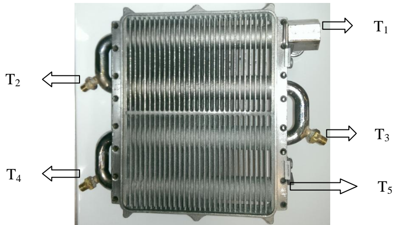
Şekil 8.6. Mevcut rekuperatör iç eşanjörü üzerinde ölçüm noktalarının belirlenmesi
