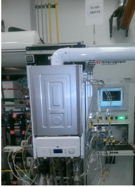
Şekil 8.18. Yeni reküperatör deney ölçümleri Şekil 8.19 Yeni reküperatör yoğuşma debisi
