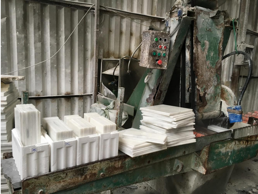
Şekil 3.1. Doğal taşların fabrikalarda ebatlanması
