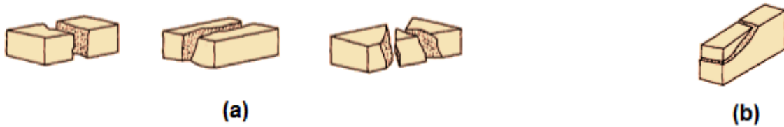
Şekil 3.15. Blok örnekler için kırılma şekilleri: a) geçerli, b) geçersiz (Ulusay vd., 2005).
