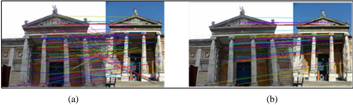
Şekil 2.3 Yerel öznitelik tabanlı imge erişimi. Sol taraftaki sorgu imgesinden çıkarılan yerel öznitelikler veri tabanındaki imgelere ait yerel öznitelikler ile karşılaştırılarak sorgu imgesine en benzer imgeler geri döndürülmektedir. (a) En yakın uzaklık kullanılarak oluşturulan eşleşmeler. (b) Geometrik kısıtların uygulanması sonucu geriye kalan eşleşmeler
