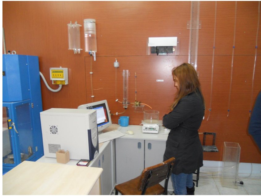
Şekil 5.6. İğne deliği deney düzeneği
